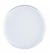
氟化碳纳米管(FCNTs)外观为粉末状固体,颜色随氟碳比提高逐渐由黑变为灰白,直至呈现白色。碳纳米管(CNTs)自上世纪 90 年代被发现后,受到了人们的广泛关注。但是由于CNTs 表面的相对惰性,且容易团聚缠绕,很难在介质中分散,限制了其应用,因此对 CNTs 进行表面修饰成为了 CNTs 研究领域的热点。FCNTs 一方面保持了其原本的三维管状结构,另一方面显著改变了其表面特性、导电性、润滑性等性质,使其可以通过亲核取代进行进一步的表面修饰,这些特点使 FCNTs 在锂电池正极材料、固态润滑、复合物填充剂等领域具有独特的用途。采用不同直径和种类的碳纳米管,可以合成具有不同直径的单壁、少壁及多壁的氟化碳纳米管。
